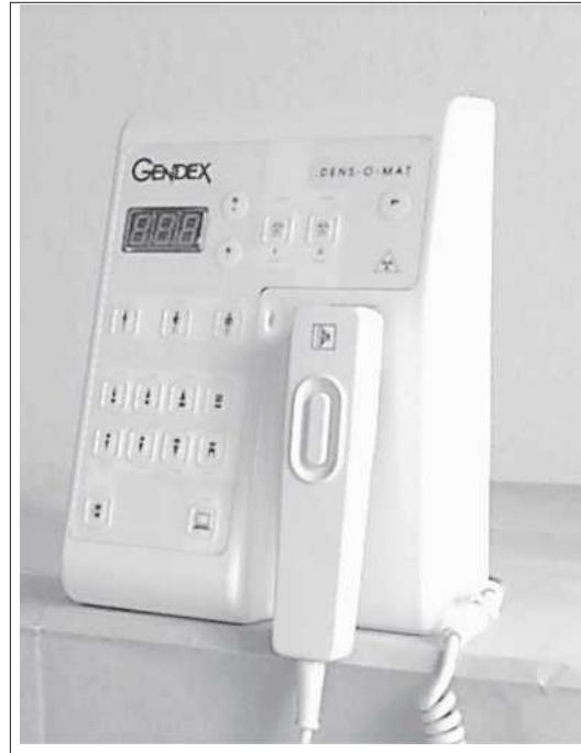
Questa apparecchiatura è inoltre dotata di altri circuiti riservati alle funzioni di sicurezza come il back up timer, con monitoraggio indipendente della tensione di rete e arresto dell'esposizione se il limite massimo di 3,2 s. viene superato.
