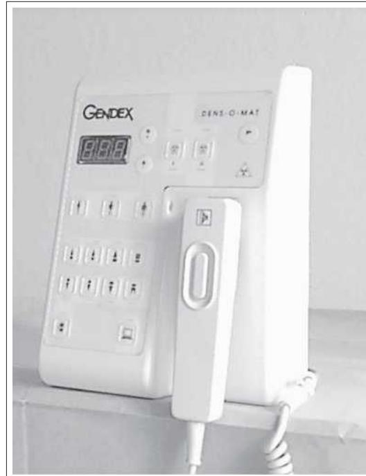
Cet appareillage est en outre doté d'autres circuits réservés aux fonctions de sécurité comme le back up timer, avec la vérification indépendante de la tension de réseau et l'arrêt de l'exposition si l'on dépasse le limite maximum de 3,2 s.
