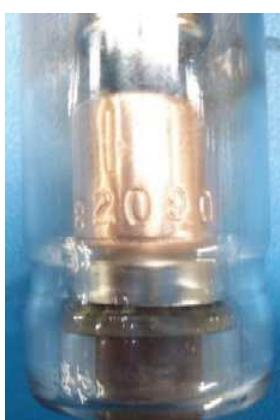
Il numero di serie del tubo a raggi X Gendex (PN 800-0003G3) è stampata sul anodo di rame del cannotto.
